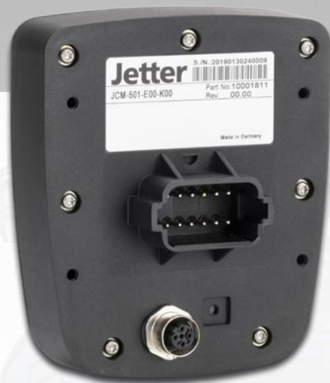
Abgeleitet vom Display-Controller JetViewMobile 104, jedoch ohne Display und Bedienelemente, ist die JCM-501 eine reine Kopfsteuerung. Durch die performante Steuerung und die hohe Konnektivität mit zwei CAN-Schnittstellen, RS232, USB und M12x1 Ethernet stellt dieses Modul die ideale Lösung für ISOBUS-Implemente dar, welche kein externes Display benötigen.
